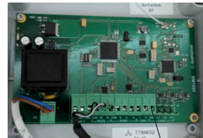
Anschlussklemmen für Eingangssignale
